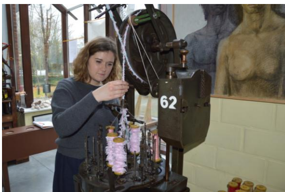
Camille Trefouel contrôle le rendu des premiers essais réalisés avec Daniel Masschelein sur une tresseuse de marque Carters.
