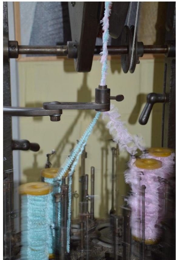
Essai de tresse avec quatre bobines de fils créés par Camille Trefouel, sans l'adjonction d'une âme centrale
