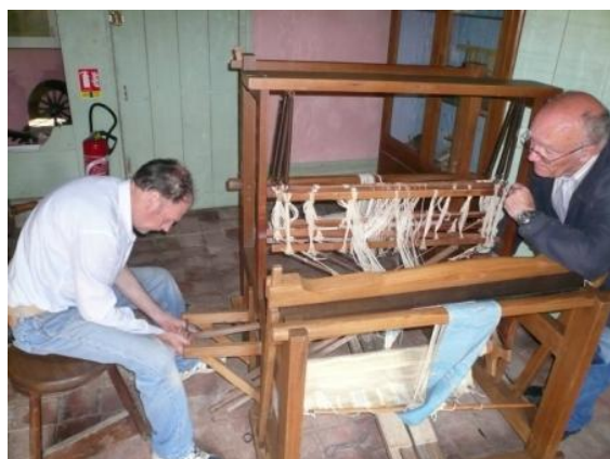
D. Masschelein et A. Verschaeve en train de remonter le mécanisme des marches du métier à tisser MRc694.
