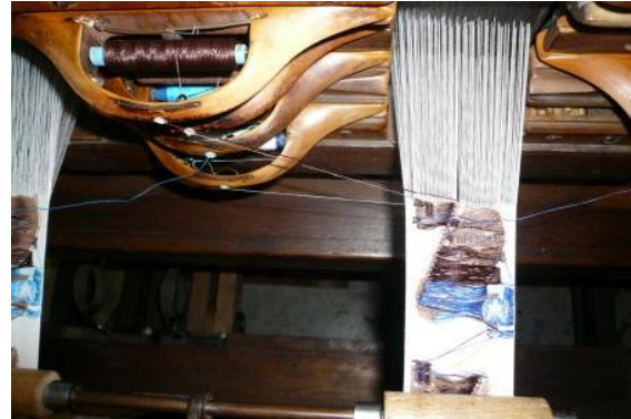
Flottées de trame d'un ruban encore sur le métier à tisser.
