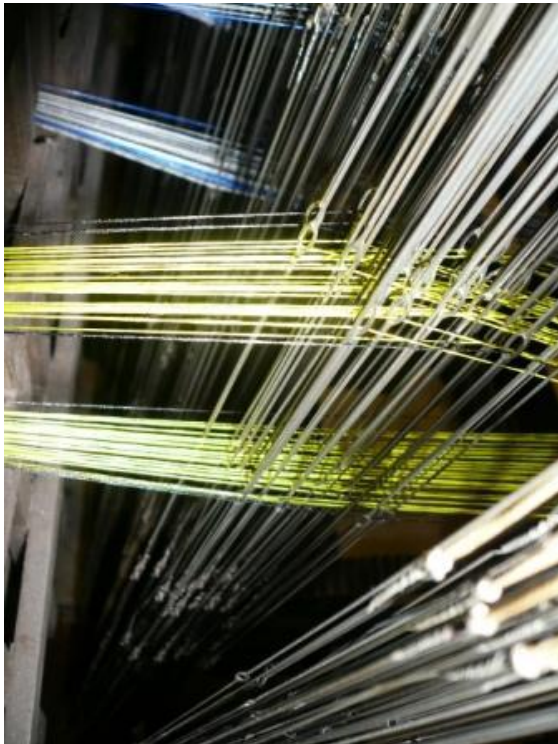
Lices, contrepoids et chaînes d'un métier jacquard.
