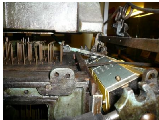
Détail d'une tête de mécanique jacquard.
