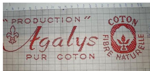
Une autre fibre naturelle transformée jadis à Pérenchies : le coton. Mise en carte d'un ruban tissé chez Dalle pour les établissements Agache (MRc1473).
