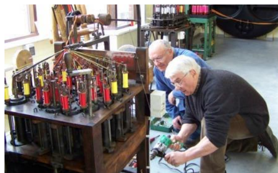
Alain Pottel et André Verschaeve en plein travail de placement du nouveau moteur de la tresseuse MRc059.
